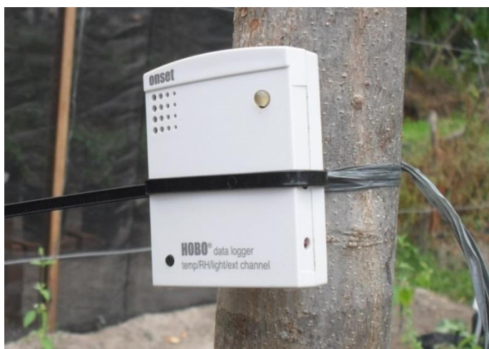
Figura 8. Data logger HOB0 temp/RH/light/ext channel – marca Onset, Redenção, Ceará, 2016.
