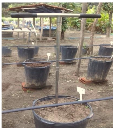
Figura 6 - Utilização do trado na coleta das amostras do substrato para caracterização química. Redenção, Ceará, 2018.
