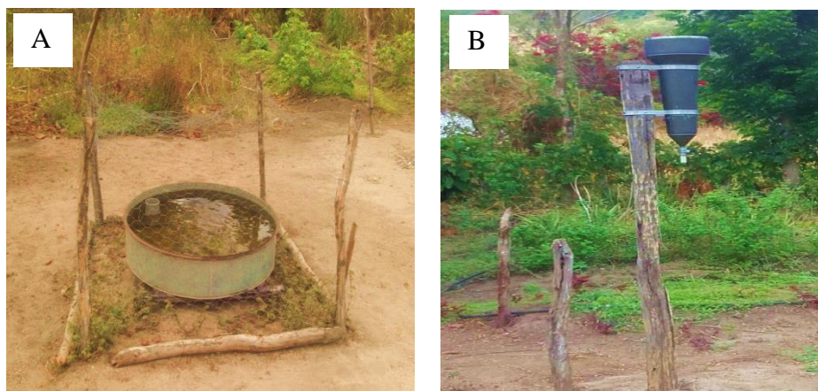
Figura 5 - Tanque classe A (A) e Pluviômetro (B). Redenção, Ceará, 2018.
